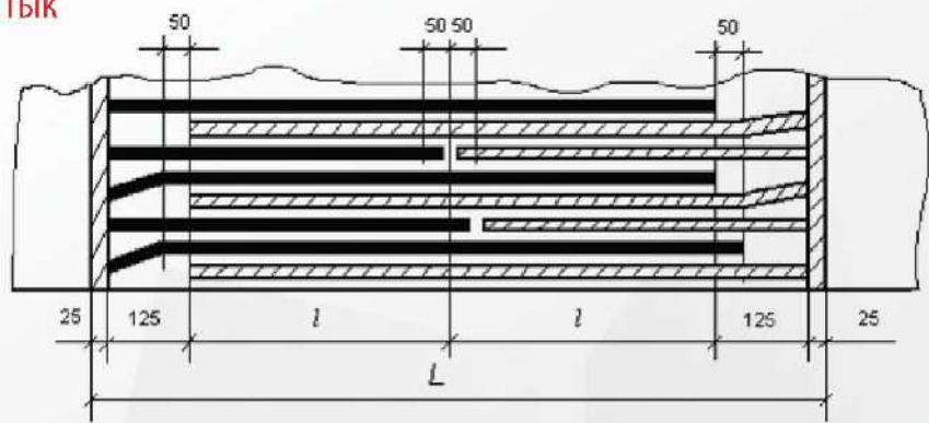
Рисунок 21 - Трехступенчатый стык
