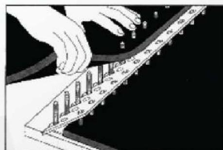
С помощью направляющей надевают на болты верхние пластины соединений, а затем на болты вручную навинчивают гайки (рис. 8).
