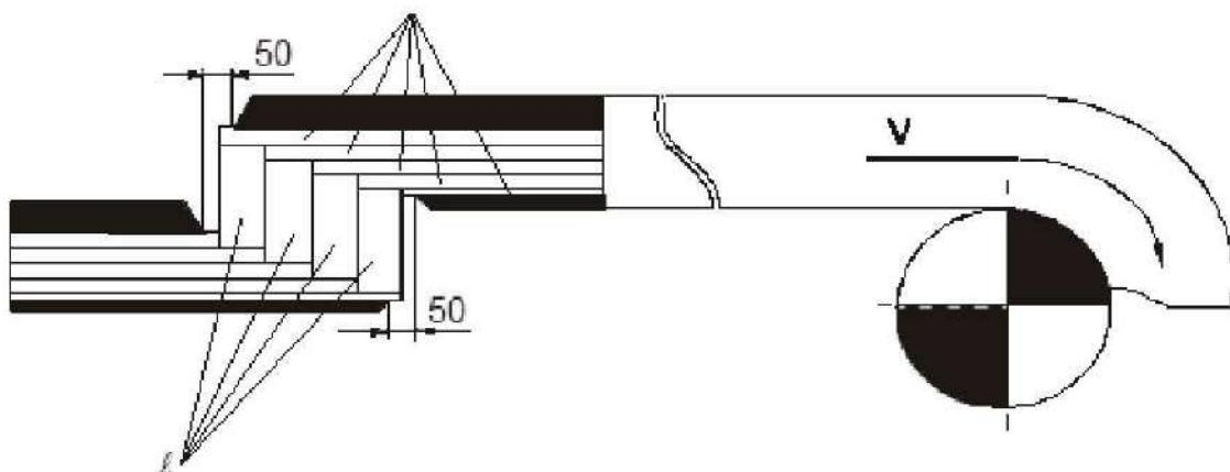
Ориентировочные данные длястыковки многослойной резинотканевой конвейерной ленты, ремня способом горячей вулканизации представлены в таблице №1, где n – число тканевых прокладок, B – ширина ленты, ремня.
