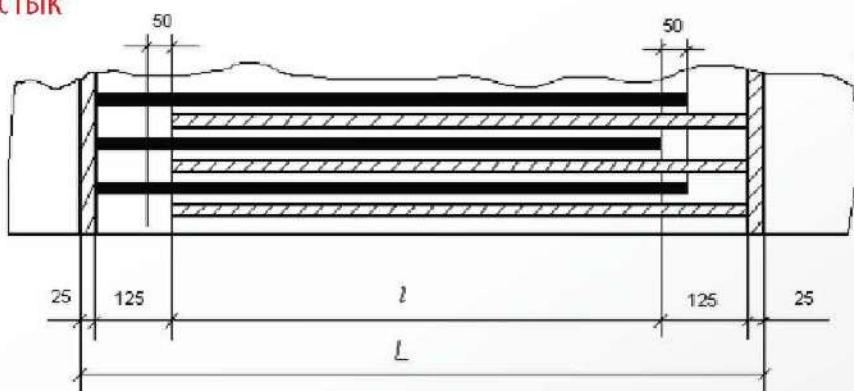
Рисунок 20 - Двухступенчатый стык
