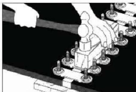
Завершается монтаж болтовых соединений отламыванием болтов (рис.11) с помощью двух обламывателей. При этом болты должны отламываться только в продольном направлении пластин, то есть перпендикулярно плоскостистыка.
