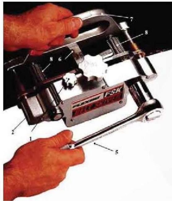
**Рисунок 17 - Установка толщины срезаемого слоя обкладки ленты**
