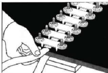
После протяжки лок-лента натягивается и закрепляется путем затягивания гаек крайней пластины. Зафиксировав лок-ленту, затягивают гайки остальных пластин соединений.
