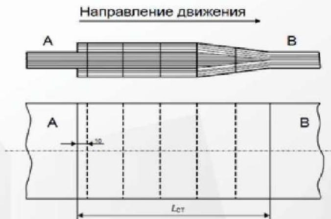
Расстояние между рядами скоб по длине стыка – 20 мм, между скобами по ширине ленты – 20 мм, между последним рядом скоб и кромкой конца расслоенной ленты – 10 мм. Скобы забиваются в ленту так, чтобы они не выступали над обкладками. Количество рядов скоб принимается по табл. 3 в зависимости от прочности ленты.
