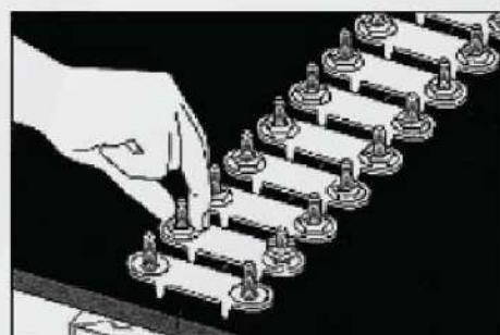
Для предотвращения попадания влаги встык ленты и просыпей мелких фракций транспортируемого материала под нижними и верхними пластинаами протягивается отрезок лок-ленты длиной 3,5 ширины конвейерной ленты. (рис.9).
